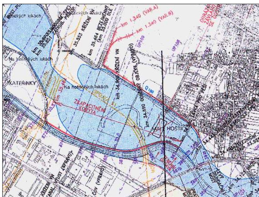
Obr. 17. Nová hráz (červená linie) podél Kateřinského potoka v Malých Hořticích znamená ochranu před průtoky do Q_{100} (zdroj: Povodí Odry, s. p.).
